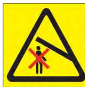
Не стойте под стрелой конвейера. Безопасное расстояние 5 м.
