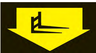
Место захвата вилочным автопогрузчиком
