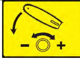
Регулировка скорости опускания пильной шины.
