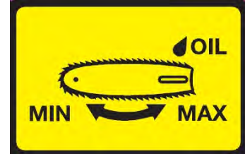
Регулировка смазки пильной шины
