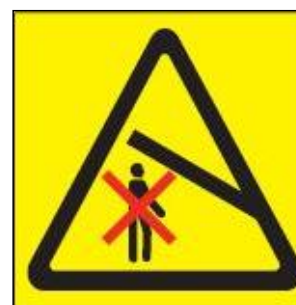
Не стойте под стрелой конвейера. Безопасное расстояние 5 м.
