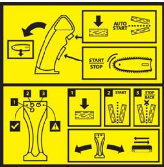
Управление подающим отпиливанием, подставкой и расщеплением транспортером, и расщеплением.
